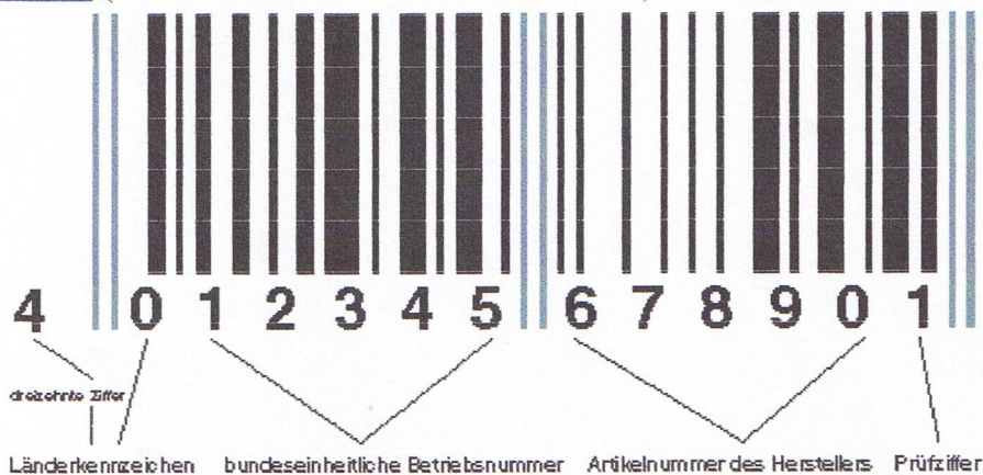
Abb. 2 (Informationsinhalt eines Balkencodes)
